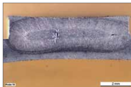
*Schweißpunkt in Aluminiumlegierung mit Rissen und Poren
